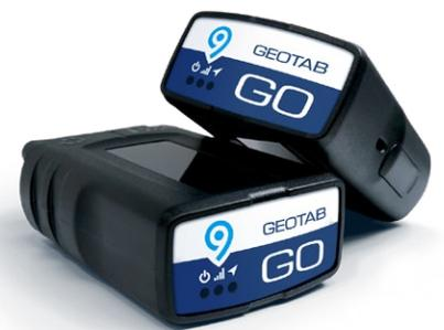
Es wurden verschiedene Fahrsituationen getestet. Dabei wurden zwei Kleintransporter verwendet, einer von ihnen beladen, um eine echte Lieferung zu simulieren. Jeder Kleintransporter war mit einem GO8 und einem GO9-Gerät ausgestattet. Die Geräte wurden jeweils verschieden konfiguriert. Eines arbeitete mit einem parameterbasierten Algorithmus, das andere mit dem kurvenbasierten. Beiden befanden sich zum Zwecke der Datenintegrität zeitgleich in Betrieb.
