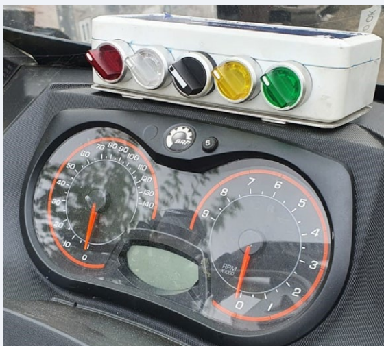
La caja de conmutación personalizada para el equipo de British Antarctic Survey, montada en uno de sus vehículos.
