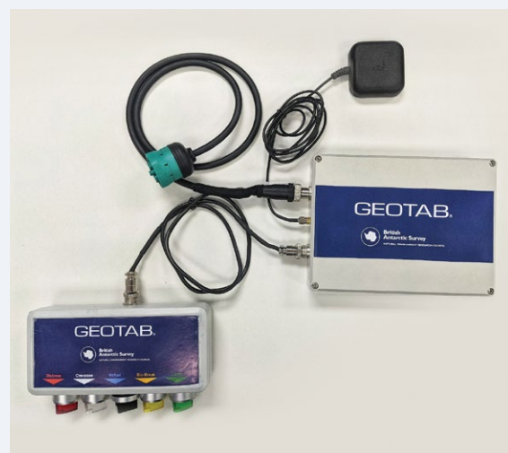
Ejemplo de caja de conmutación y caja del dispositivo GO de Geotab del equipo de British Antarctic Survey.
